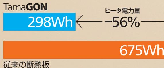
金型取付板: 220mmx150mm / 金型温度: 140°Cの場合の実測値
